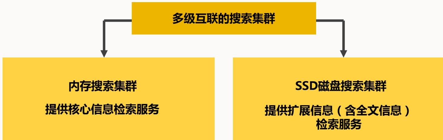
每一部分包含若干组结构相同的服务器，每一组服务器又分为检索根节点、检索父节点和检索子节点三个层级。通过这种多级互联的方式实现负载均衡，保证高并发情况下的检索效率。
